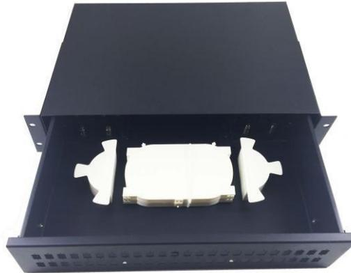
El ODF de distribución de fibra óptica con bastidor tiene accesorios deslizantes de acero frío con funciones de autobloqueo que evitan que el bastidor se caiga al moverlo; montaje en bastidor de 19 pulgadas para adaptadores ST, SC, LC, FC. El rack es la tabla de sujeción para el empalme, fácil de retirar las fibras al hacer las pruebas y la distribución.
